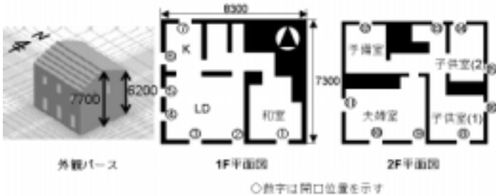
図1 解析対象住宅モデル (単位:mm) 表1 窓の開放条件
