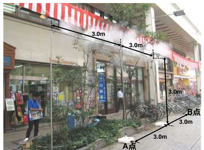
図2 屋外でのミスト噴霧実験の概要（古町モール）
