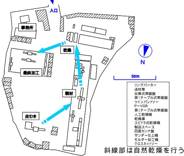
図8 対象製材所配置図及び主な加工機械
