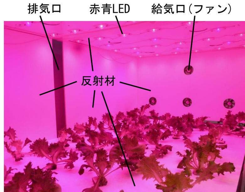
図4 光・空調制御ダクト型栽培実験装置の内部
