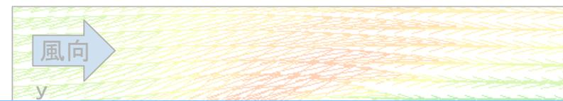
case1-1と同様に、風下側開口から断続的に気流が流入するが、建物隅角部で生じる気流の剥離の影響で、**風上側開口から流入するタイミングがある。**
