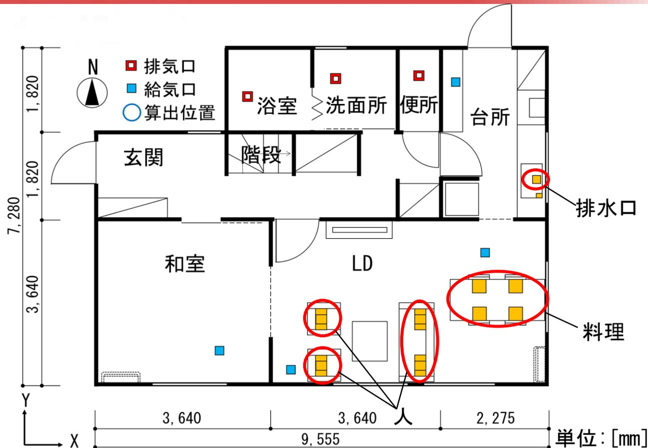
図1 解析対象モデルの概要と基準化濃度の算出位置
