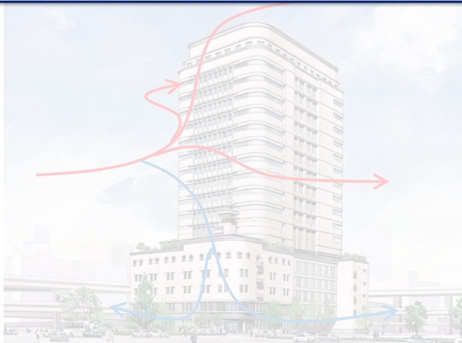
図 ビル風の三次元的な流れ構造のイメージ
