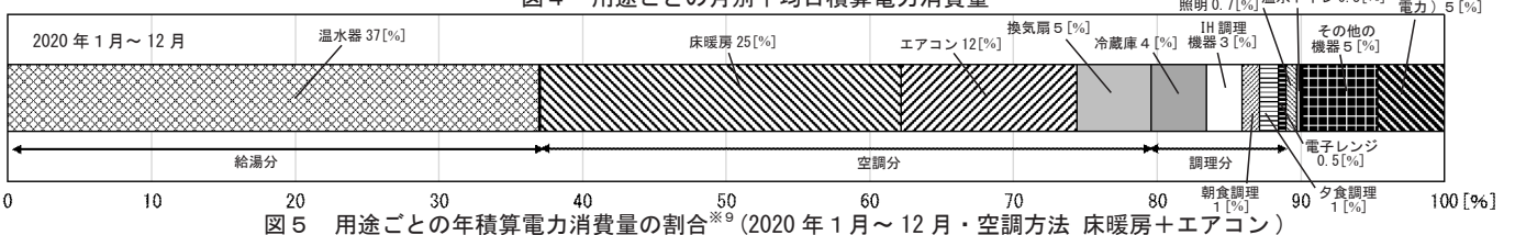
図5 用途ごとの年積算電力消費量の割合(2020年1月～12月・空調方法 床暖房+エアコン)
