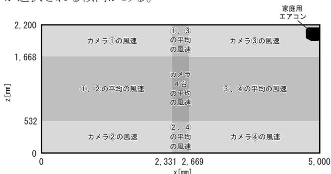
図 2 可視化断面の各範囲における PIV 解析結果の合成方法
