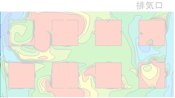
給気口 (f) case2-3 (壁から給気) (壁) (発生位置: 葉の裏面)
